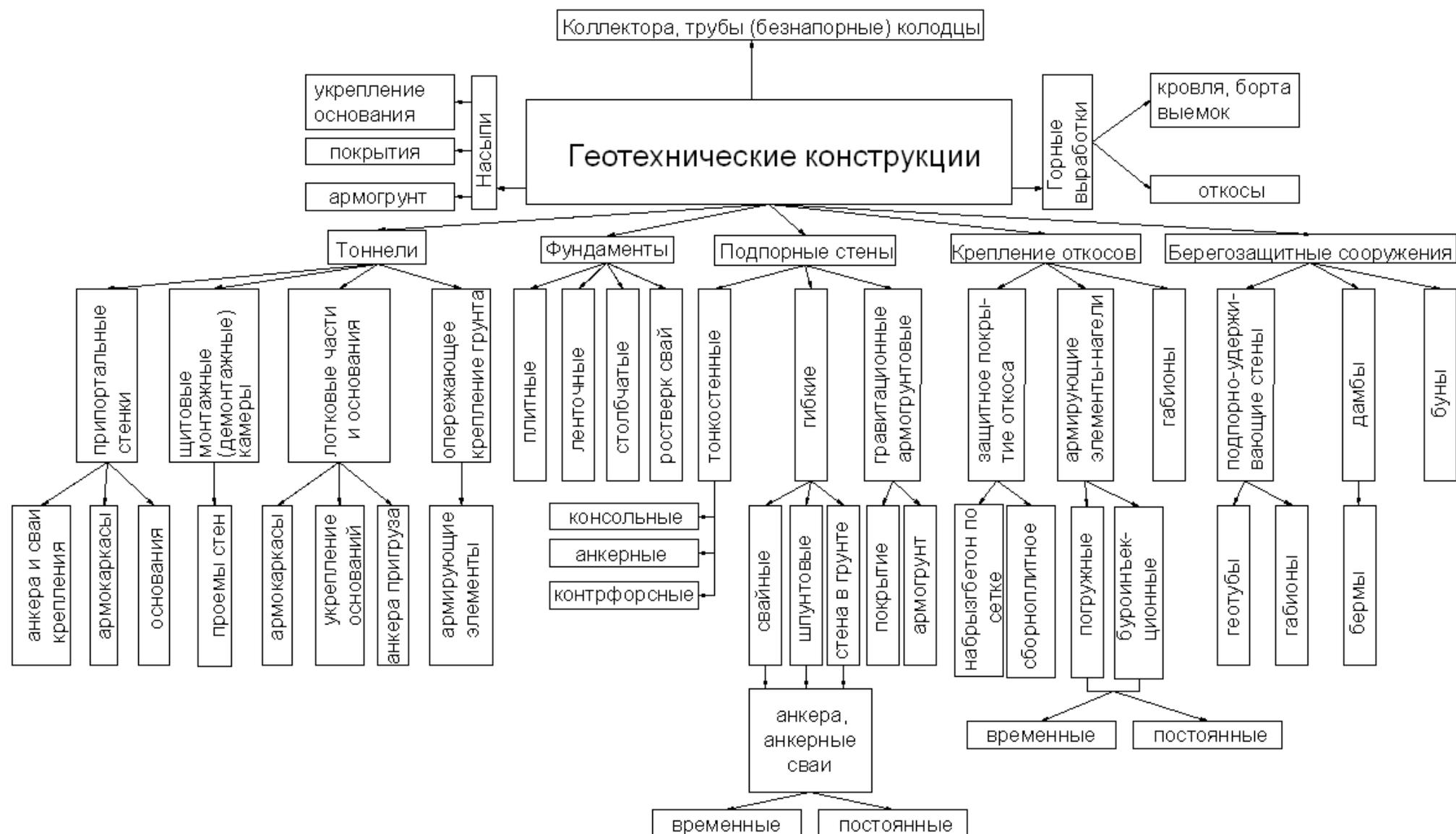
Рисунок 8.1 – Классификация геотехнических конструкций с возможным применением АНК
